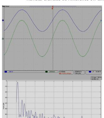
Figura 2. (a) Tensão (canal azul) e corrente (canal verde) observadas para a lâmpada incandescente de 100W / 127V. (b) Espectro em frequência da corrente da lâmpada incandescente de 100W / 127V.
