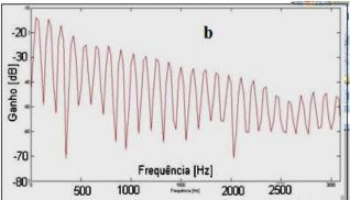
Figura 1. (a) Tensão (canal azul) e corrente (canal verde) observadas para a lâmpada da Foxlux 127V / 30W. (b) Espectro em frequência da corrente da lâmpada da Foxlux 127V / 30W.
