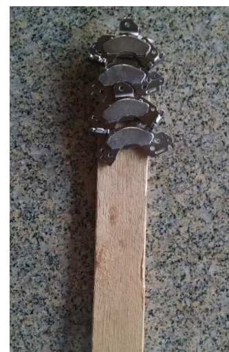
Figura 5. Madeira de apoio com os ímãs presos de forma a somar seus fluxos
