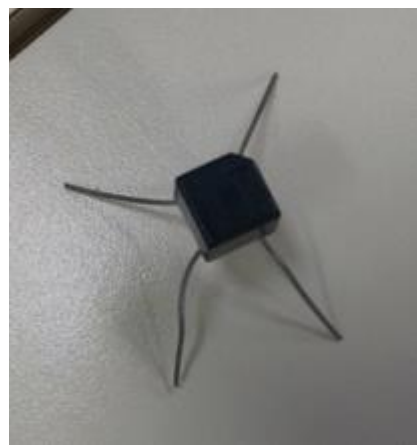
Figura 2. Ponte retificadora utilizada no modelo em pequena escala
