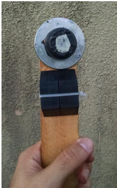
Figura 6. Modelo da fixação do concentrador de fluxo, a ser preso em uma boia (visão frontal)
