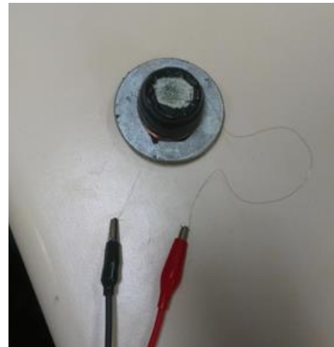
Figura 4. Concentrador de fluxo com espiras enroladas, presas com fita isolante
