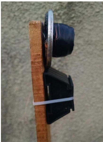
Figura 7. Modelo da fixação do concentrador de fluxo, a ser preso em uma boia (visão lateral)
