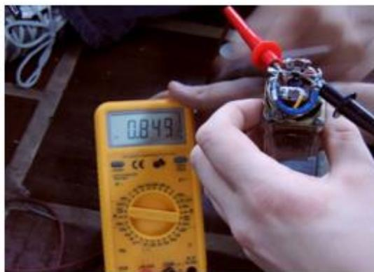
Figura 13: Bobina gerando corrente.
