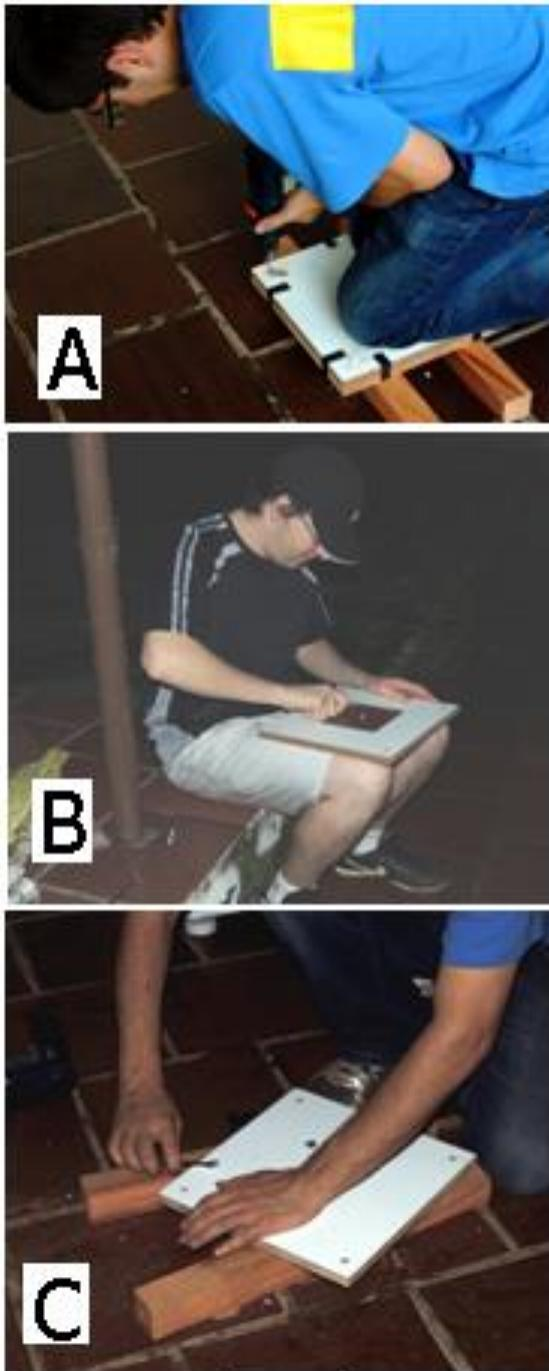
**Figura 2.** Montagem: A- Placas de madeira sendo furadas; B e C - Parafusando os rolamentos.
