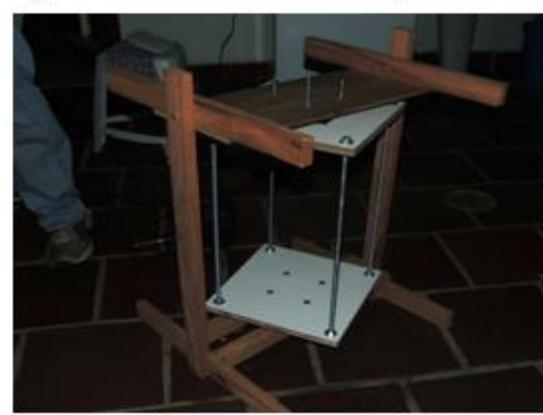
Figura 6. Suportes laterais da estrutura.
