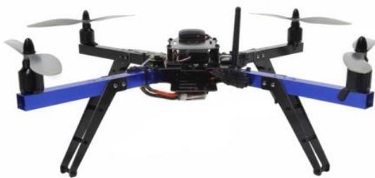
**Figura 5.** VANT 3DR RTF Quad, planador com 4 motores elétricos, vendido pela internet (opcionais desde peças reservas, controles remotos mais potentes até câmeras montadas). Preço 600- 1000US\$. Com ajuda do fórum é possível fazer um equivalente com peças salvas.(www.diydrones.com)
