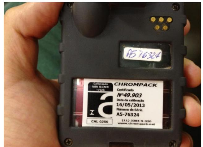
**Figura 2:** Selo de validade da calibração do equipamento utilizado.
