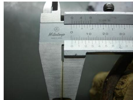
**Figura 4:** Espessura do sensor.
