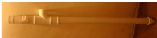
**Figura 3.** Fundo do separador com a tampa de rosca.
