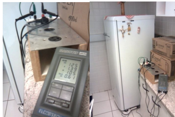
Figura 1. Aparelhagem de medida (NANOVIP) e montagem experimental
