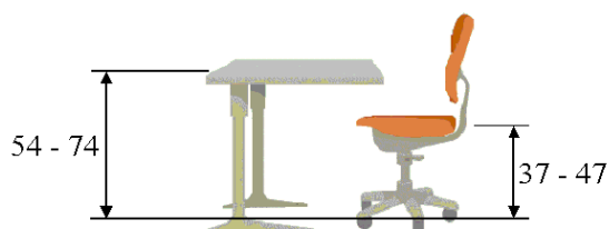
Figura 3. Dimensões recomendadas para salas de aula (cm).
